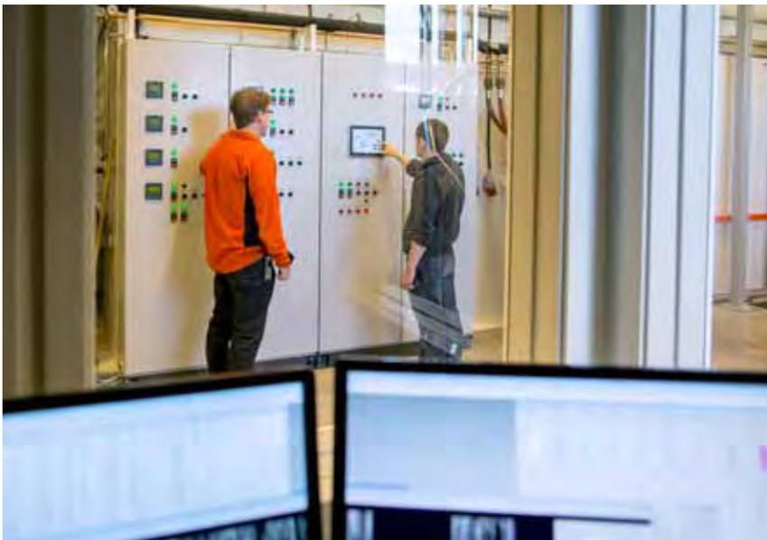
Im Dezember 2012 wurde eine supermoderne Testanlage für Luft-/Wasserwärmepumpen in Betrieb genommen, die im Zuge von Funktionsprüfungen eine vollständige Simulation verschiedener Klimabedingungen ermöglicht.
