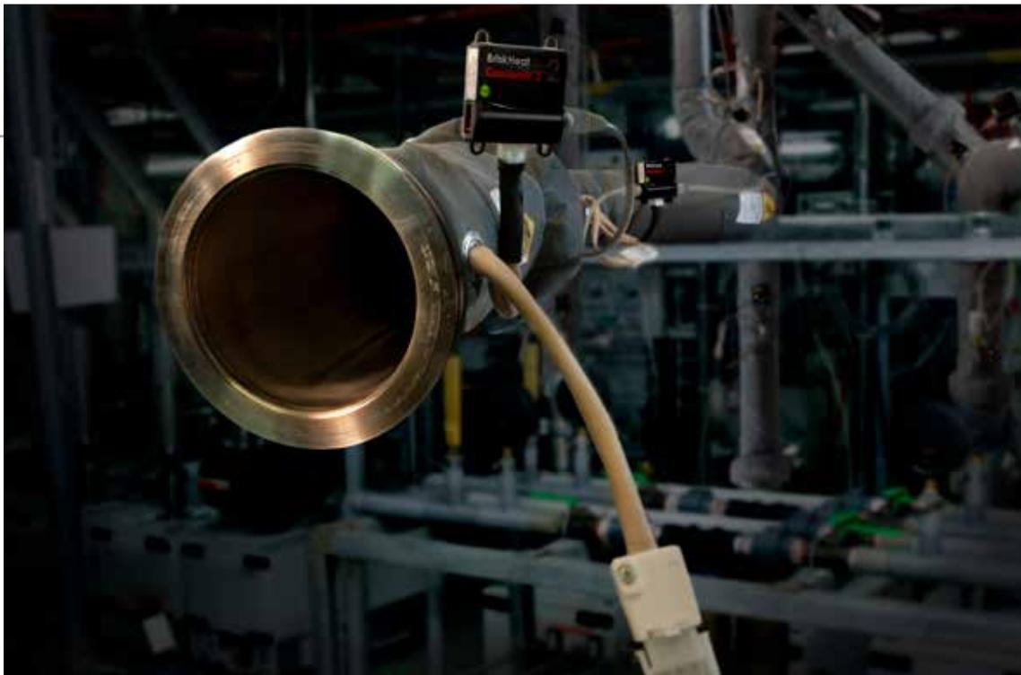
Qualitätswärmemäntel mit Temperatursteuerung sind entscheidend für die Vermeidung von Kondensation und von Unterbrechungen in Prozessen wie beispielsweise bei der Herstellung von Halbleitern.
