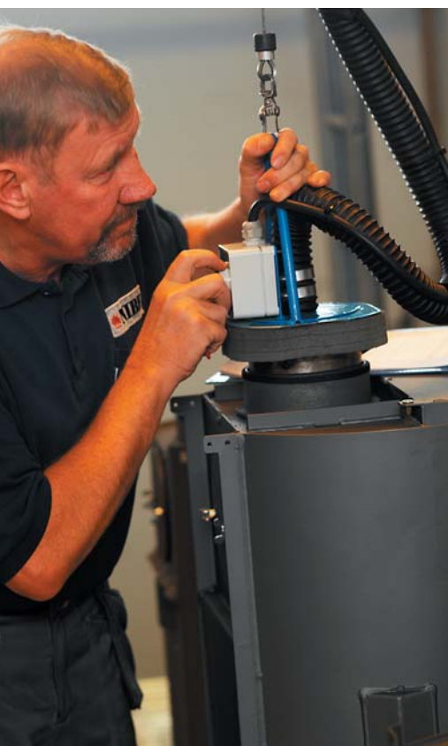
Bo Dehlin täthetsprovar en braskamin före leverans.
