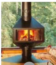
Handöl 2 Vedmängd 4 kg/h Verkningsgrad 40%
