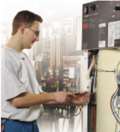
Sämtliche Abluftwärmepumpen werden einer Betriebsprüfung unterzogen, bevor sie die Produktion verlassen.
