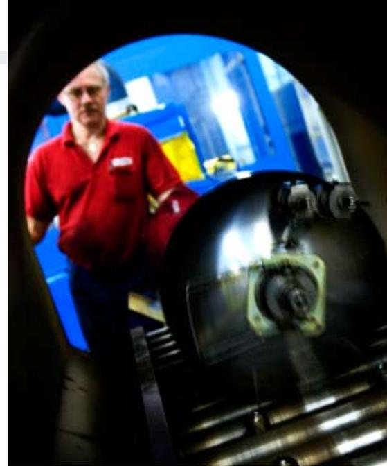
Alle Wasserwärmer aus Edelstahl werden in der Vakuumkammer auf Dichtigkeit geprüft.
