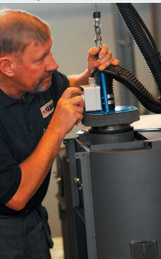
Bo Dehlin prüft vor der Lieferung eines Kaminofens dessen Dichtheit.
