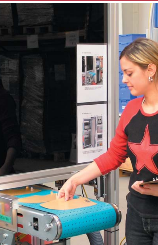
Alle Folienelemente werden vor der Auslieferung einer Okularinspektion unterzogen, wie hier durch Joanna Stanczewska bei Backer OBR.
