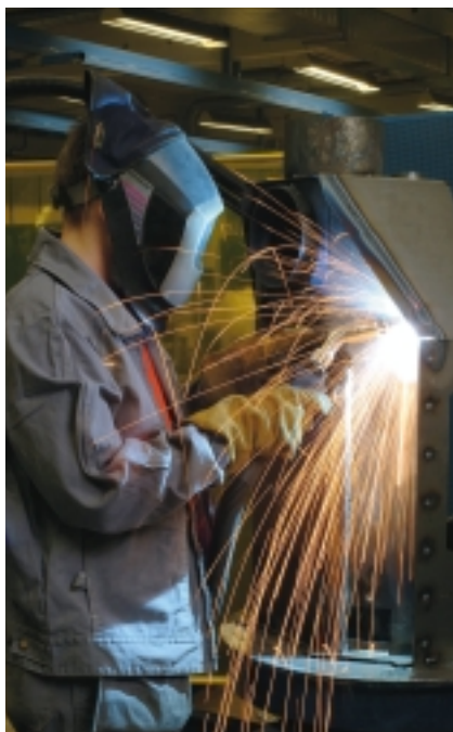
Die Kaminöfen werden hauptsächlich in Schweißautomaten geschweißt, wenn auch gewisse Momente von Hand gefertigt sind.
