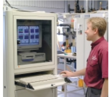
Sämtliche Abluftwärmepumpen werden einer Betriebsprüfung unterzogen, bevor sie die Produktion verlassen.
