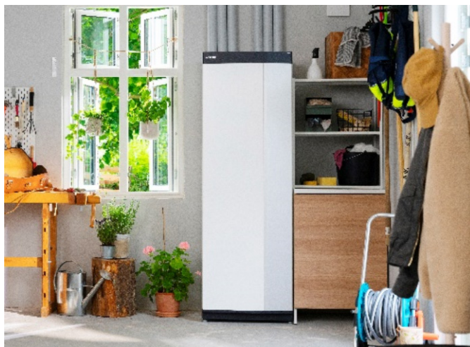
NIBEs nylanserade A+++ bergvärmepump i S-serien är en intelligent inverterstyrd värmepump med integrerad varmvattenberedning och klimatvänligt köldmedium. Den så kallade årsverkningsgraden (SCOP) uppgår till hela 6,22, vilket betyder att 1 kWh elenergi ger 6,22 kWh värmeenergi. S-serien har även inbyggt wifi och möjligheter till trådlösa tillbehör.
